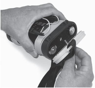
Рис. 3: Снятие крышки с отсека батарей
