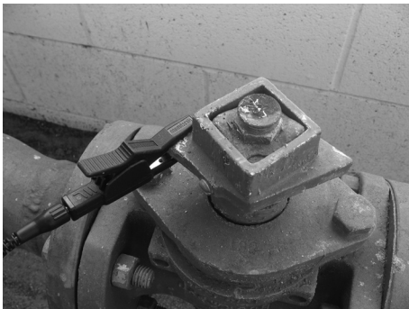
Рис. 7: Соединение прибора ST-305 с магистралью
