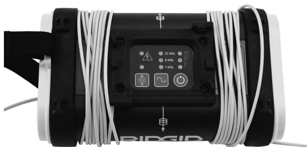
Рис. 11: Прибор ST-305 в индукционном режиме на частоте 33 кГц
