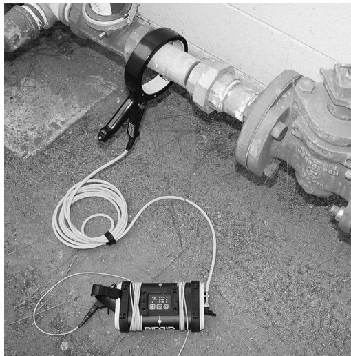
Рис. 9: Индукционный зажим присоединен к проводнику
