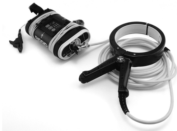
Рис. 8: Прибор ST-305 с индукционным зажимом
